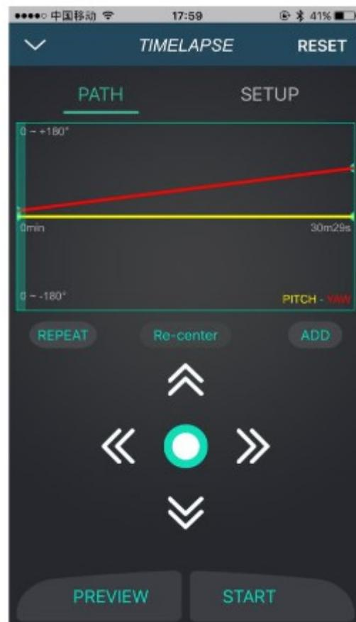
5 - Appuyez sur « SETUP » pour paramétrer le « Shutter Interval », « Shutter Duration » (plus court qu'interval), « Target Clip FPS » et « Target Clip Length ». (en français, l'intervalle entre deux obturations, la durée d'obturation, le nombre d'image par minute du clip souhaitée, la durée total du clip souhaitée)
